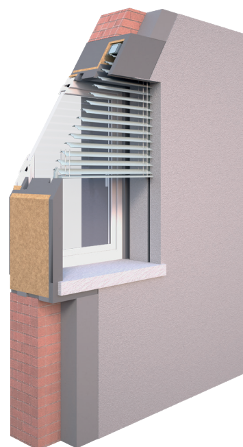
Posizionamento del monoblocco Frangisole nel foro del muro.
